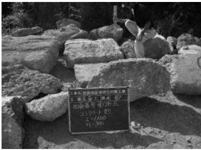
液状化対策工事で出土したコンクリート殻
