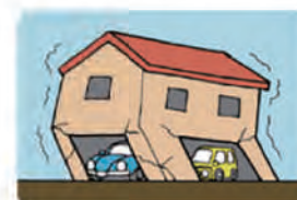
耐力壁の不足や片寄り
