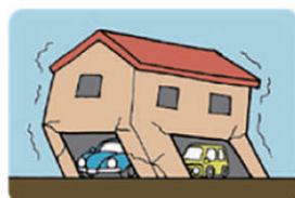
耐力壁の不足や片寄り
