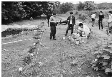
並べて挿した棒に電気を流して調査する電気探査
